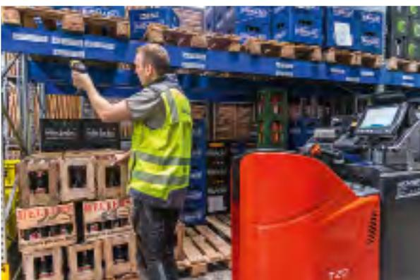
**diterminal**: Das System für die **beleglose Kommissionierung** erstellt digitale Lieferscheine für die Kommissionierer am Lager. Der Datenabgleich findet über WLAN statt. Das heißt, alle Aufträge können in Echtzeit verfolgt werden. Vor der Übertragung an **dicommerce** findet eine Kontrollzählung aller gepackter Artikel statt. Fehlauslieferungen werden so vermieden.
